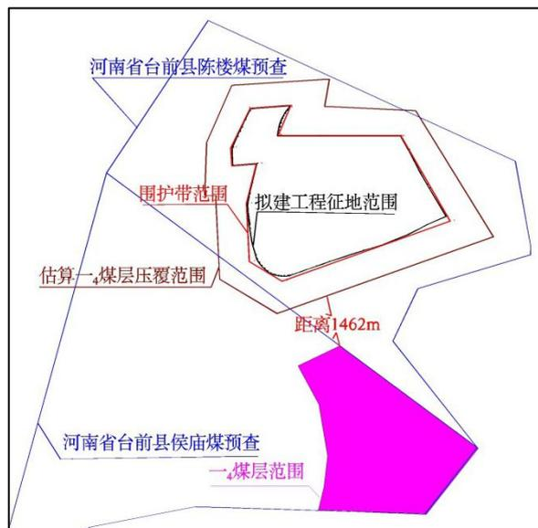
图 3-2 拟建工程与侯庙一<sub>4</sub>煤层套合平面示意图
