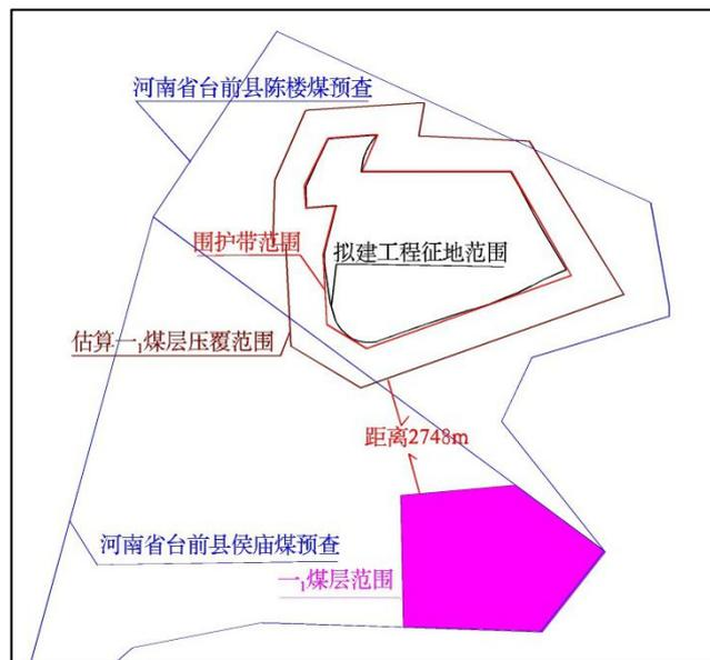
图 3-3 拟建工程与侯庙一<sub>1</sub>煤层套合平面示意图
