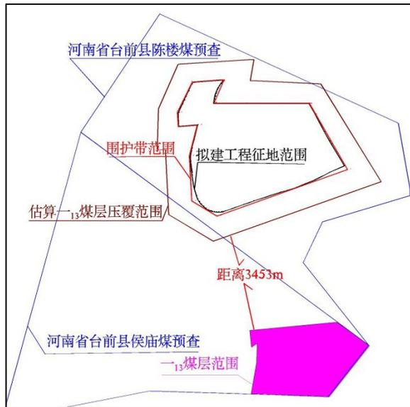
图 3-1 拟建工程与侯庙一<sub>13</sub>煤层套合平面示意图
